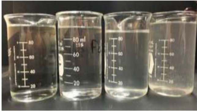
Fig. 2 Solution of 0NTU, 20 NTU, 50 NTU and 100 NTU.
